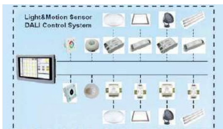
ارتباط چراغ، سنسور، پنل کنترل و غیره بر روی یک خط DALI
